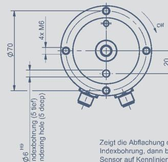
Zeigt die Abflachung der Welle in Richtung Indexbohrung, dann befindet sich der Sensor auf Kennlinienmitte.
