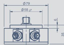
Zentrierung am Gehäuse an Wellen- und Deckelseite
