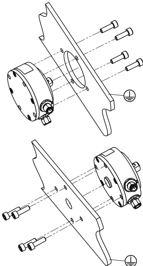
Standardmontage unter Verwendung des Zentrierdurchmessers auf der Wellenseite D58g7 (-10 / -40 µm) mit 4 x M6 Schrauben, Drehmoment 7... 9 Nm bei min. 15mm Einschraubtiefe.
