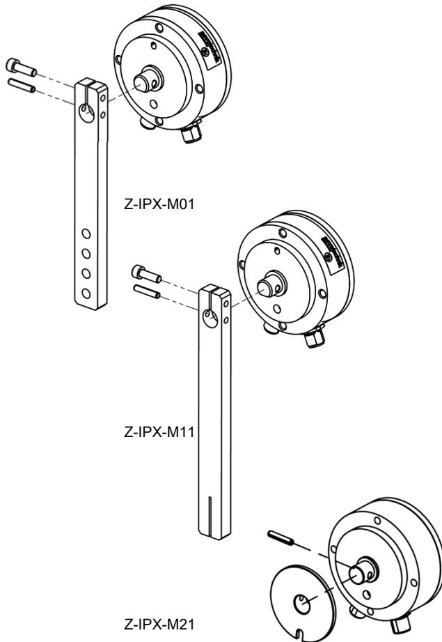
Montage des Anlenkhebels **Z-IPX-M01** 165 x 20 mm an Sensorwelle mittels Schraube und zusätzlicher Absicherung mit Schwerspannstift.
