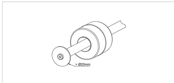
选用悬浮式磁块时，为避免磁块跌落，应在传感器测棒底部加装垫片；此时需要选择测棒底部留有内置螺纹的传感器规格。（具体见订货代码）
